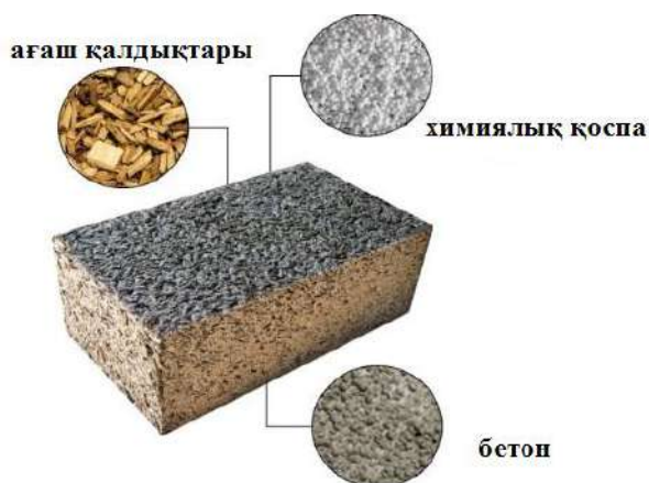
Сурет 1. Ағаш қалдықтары негізіндегі арболиттің құрылымы
