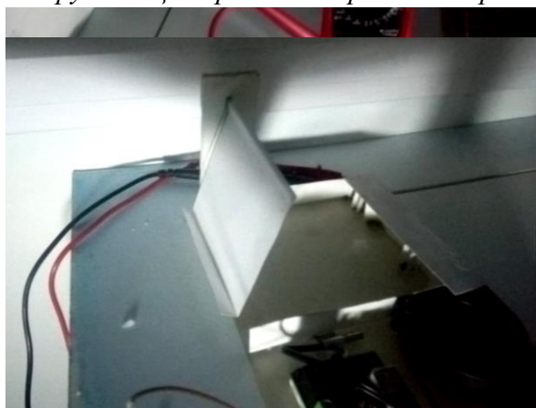
Рис.5 Определение скорости воздушного потока по отклонению листа известной массы.
