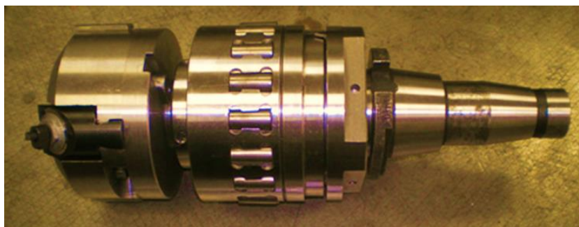
Рисунок 3 – Комбинированная развертка Рубахиных
