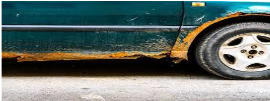
Рисунок 2. Дефект на крыле автомобиля по причине наличия острых кромок и углублений
