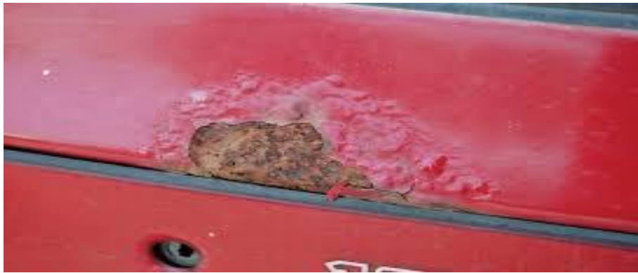
Рисунок 1. Дефект эксплуатационный на кабине автомобиля
