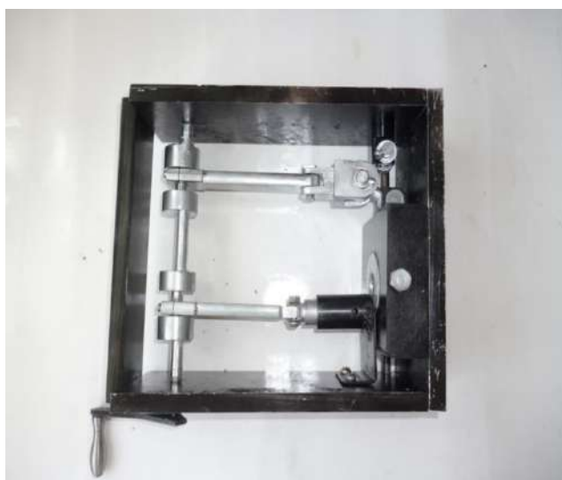
1 сурет - Құю және экструзияны біріктіруге арналған машинаның тәжірибелік нұсқасы
