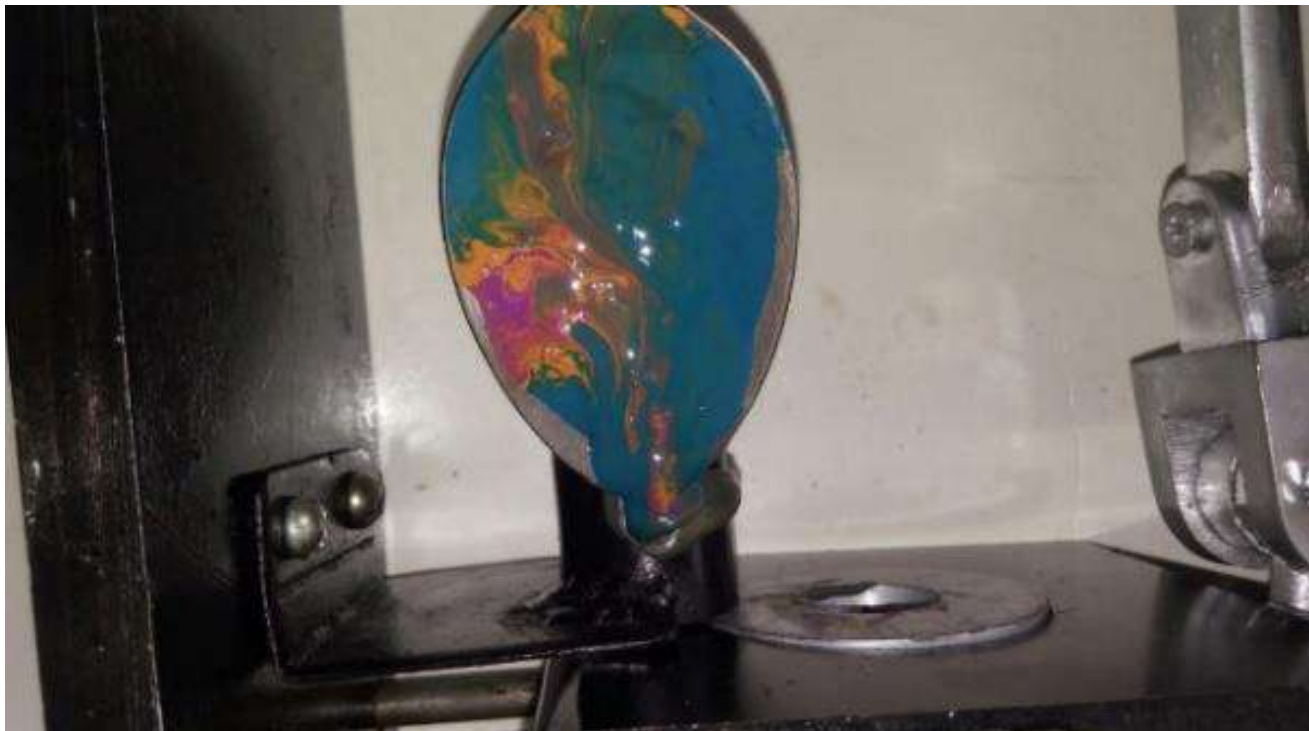
4 сурет - Сұйық массаны цилиндрлік жеңге құю процесі
