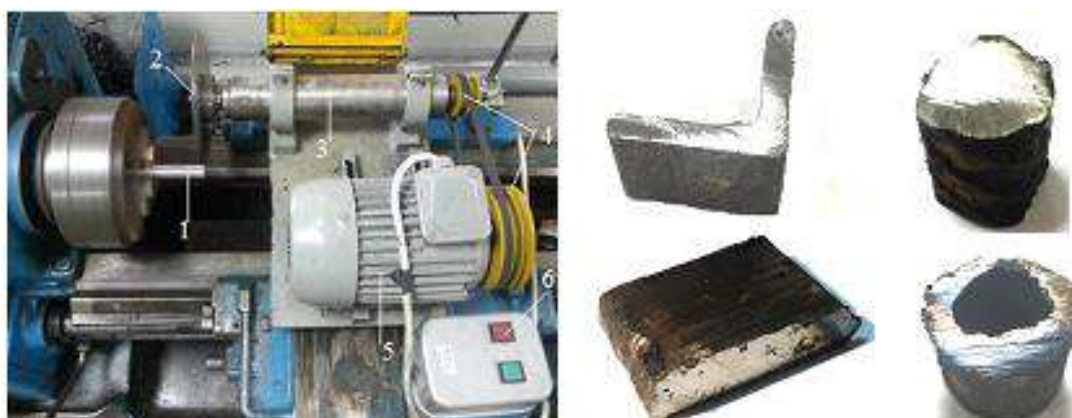
Рисунок 2 - Процесс термофрикционной резки и отрезанные образцы сортового проката
